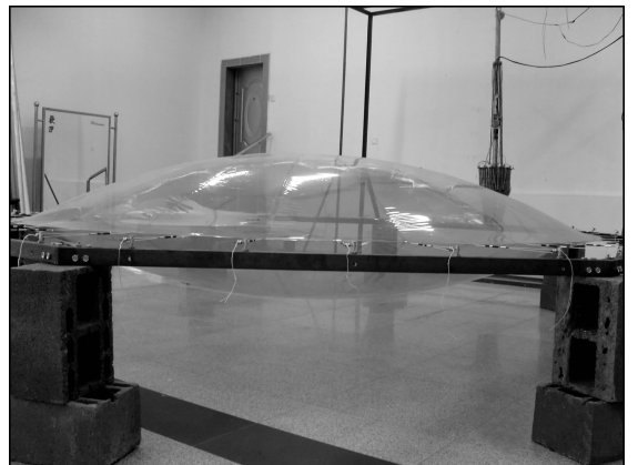
图 4 加工完成的充气天线
