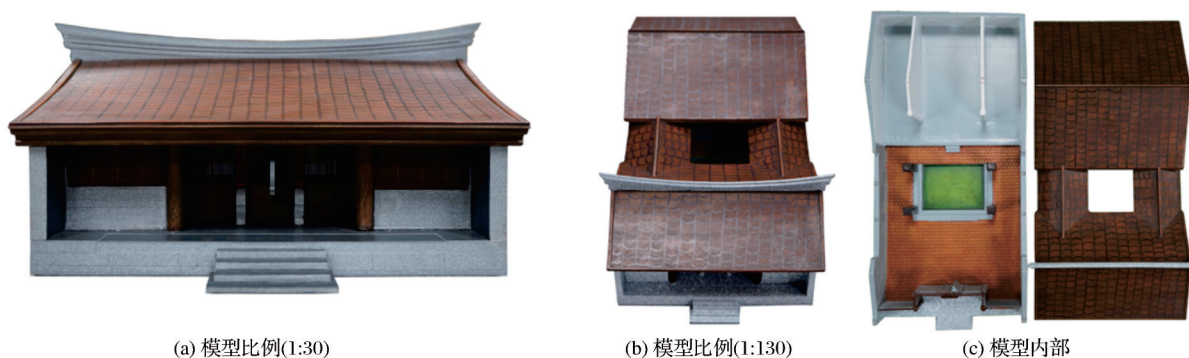
图9 古建筑3D打印模型
