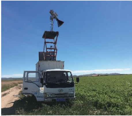
图1 车载L波段被动微波观测系统
