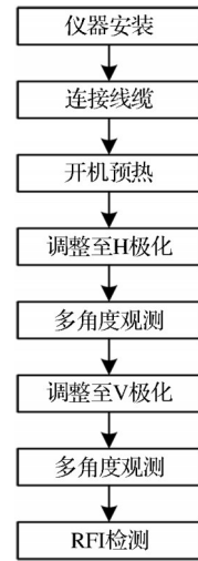
图2 被动微波观测系统工作流程
