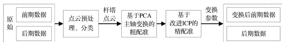
图1 输电通道机载LiDAR点云多级配准流程
