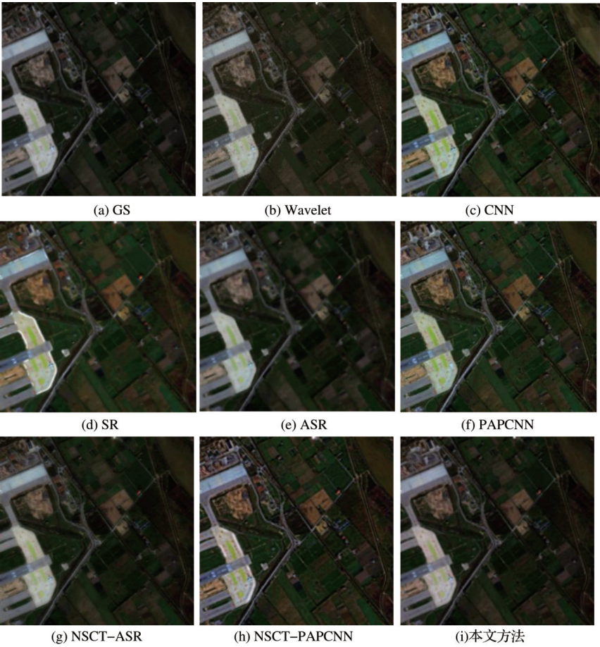
图 7 SPOT 6 影像融合效果 Fig7 SPOT 6 image fusion effect
